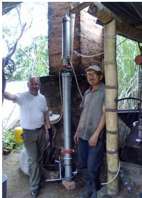
Modelo final de 4" en hierro galvanizado
